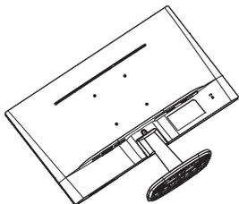
2. Нажмите фиксаторы, чтобы отсоединить подставку монитора от основания.
